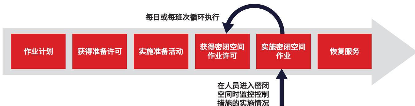
图 2：作业许可过程的流程示意图
